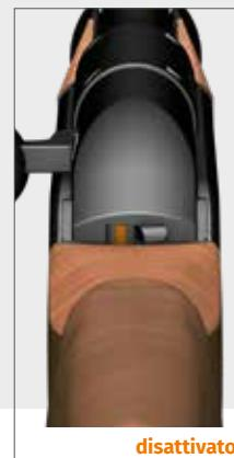
Se il dispositivo di bloccaggio del trasporto è attivato, la leva di armamento può continuare ad essere azionata; tuttavia tutte le altre funzioni sono disattivate. Il percussore è così bloccato!
